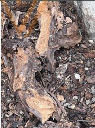
Photo n° PhTer001 Localisation : Parties extérieures Ouvrage : Débris de végétaux Parasite : Présence d'indices d'infestation d'autres agents de dégradation biologique du bois, Type non spécifié Indices : dégradation du bois, présence de vermoulure (dégradation(s) importante(s), présence étendue)
